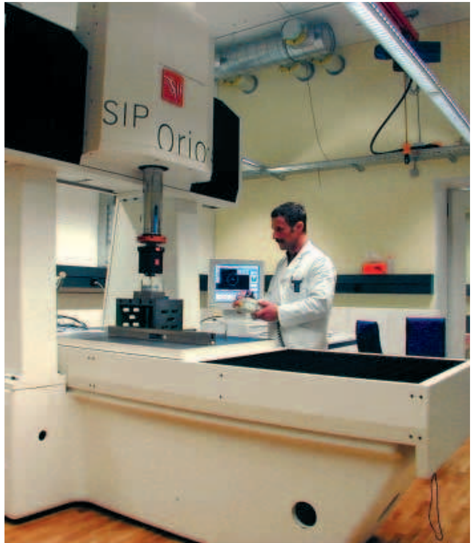
1: Koordinatenmessgerät zur Messung dreidimensionaler Werkstücke.
