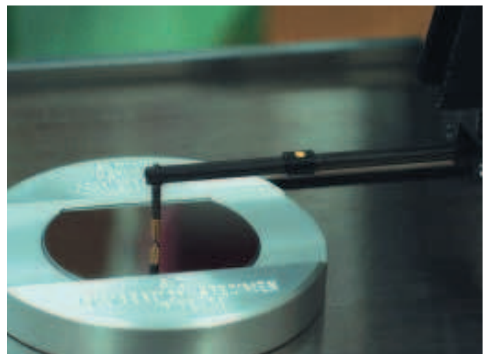
5: Mit einem Tastschnittgerät werden feinste Oberflächenstrukturen erfasst.
