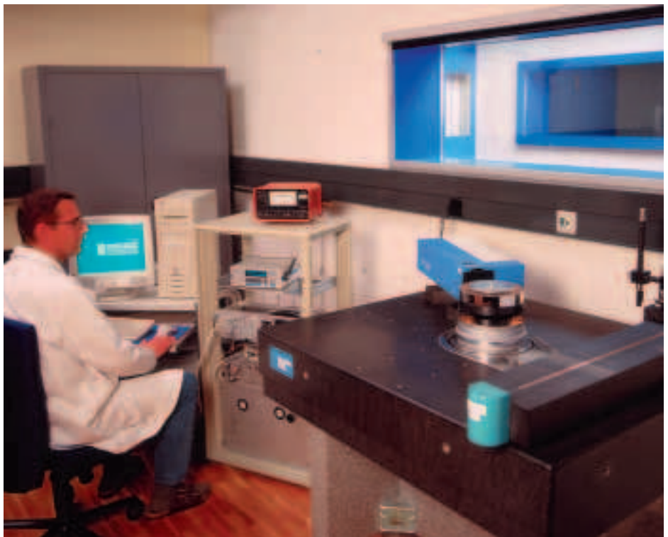
2: Numerisch gesteuerter Winkelmesstisch.
