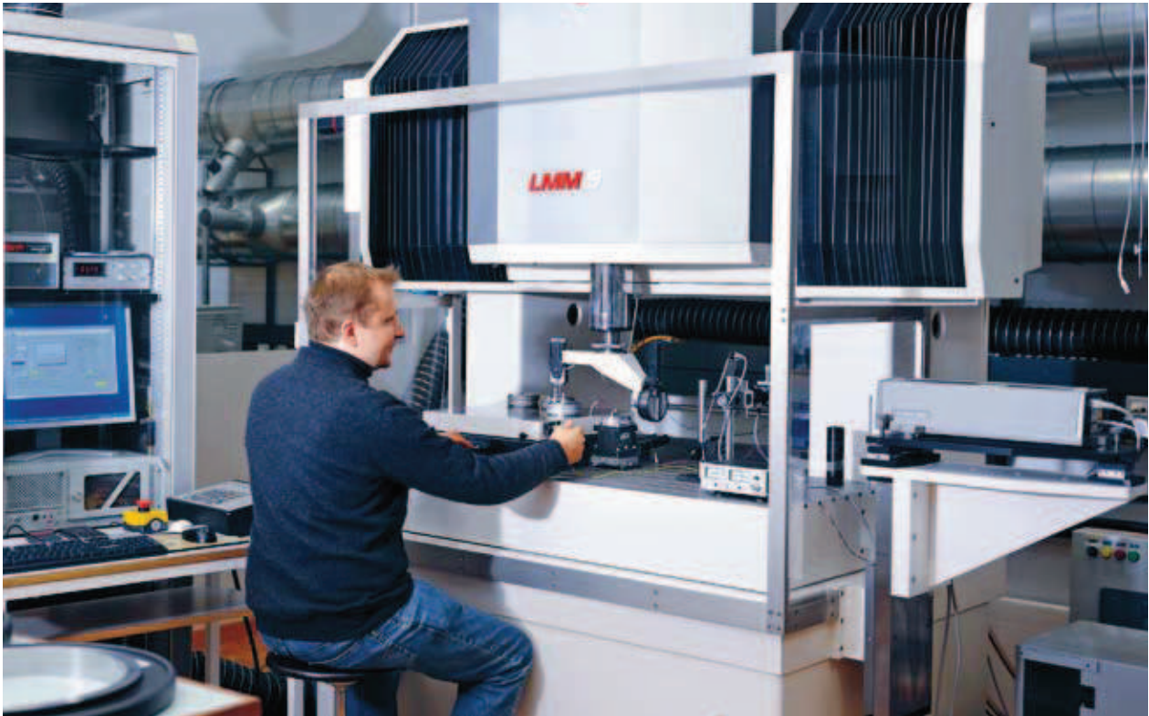
2 METAS-Lehrenmessmaschine LMM5 zur Kalibrierung von zylindrischen Lehren, Gewindelehren und Stufenendmassen.
