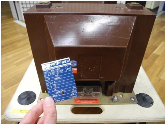
Fig. 12: Wandler vom Typ WD-24m. Das Typenschild ist nicht genügend gesichert. Es hat sich vom Gerät gelöst.
