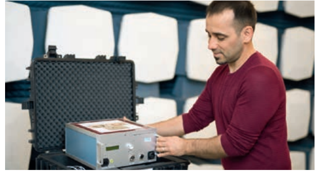
4 : Appareil pour valider les essais d'immunité conduite selon la norme IEC 61000-4-3.
