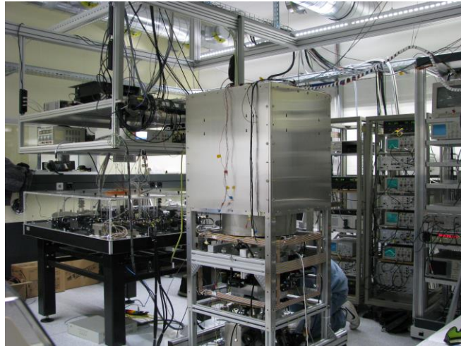
Fig. 4. Das Primärfrequenznormal FOCS von METAS.
